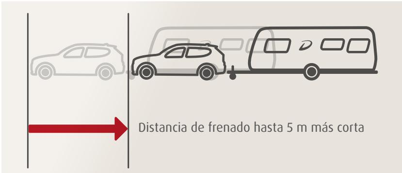
+ Los frenos de reajuste automático garantizan una distancia de frenado óptima y más corta
