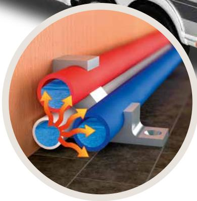
+ Las tuberías de agua se colocan directamente sobre los tubos de calefacción para protegerlos así de las heladas (imagen: calefacción de agua caliente)
