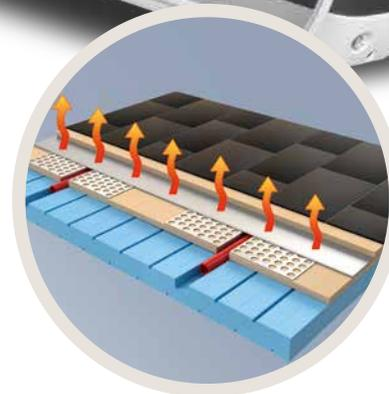
+ La calefacción de suelo radiante, tanto de agua caliente como eléctrica, procura un caldeoamiento uniforme de su caravana y le mantiene los pies calientes
