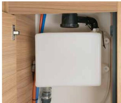
+ Depósito aguas residuales instalado en el interior, protegido de las heladas (opc.)
