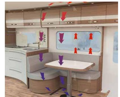
+ Sistema Air-Plus para la circulación de aire detrás de los armarios altos
